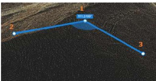
14. 計3ヶ所をクリックすると、計測結果が画面上に表示され、レイヤーパネル、情報パネルに計測結果が登録されます
