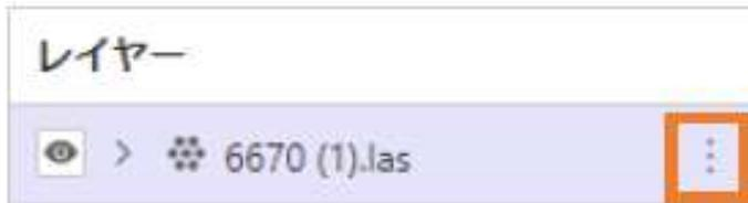
5. 点群の3Dモデルを表示中に表示設定を選択すると、不透明度を変更することができます
