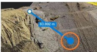
4. 計測点を移動すると、それに合わせて計測結果が変化します
